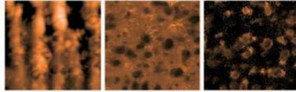
高低差像 貯蔵弾性率像 損失弾性率像
